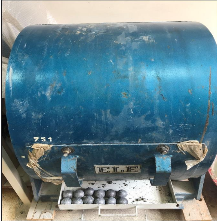
Şekil 3.3. Los Angeles aşınma deneyi
