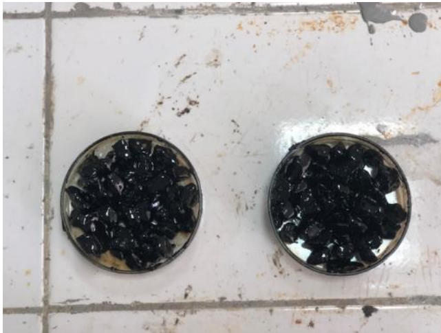
Şekil 3.6. Soyulma deneyi, petri kabındaki numuneler
