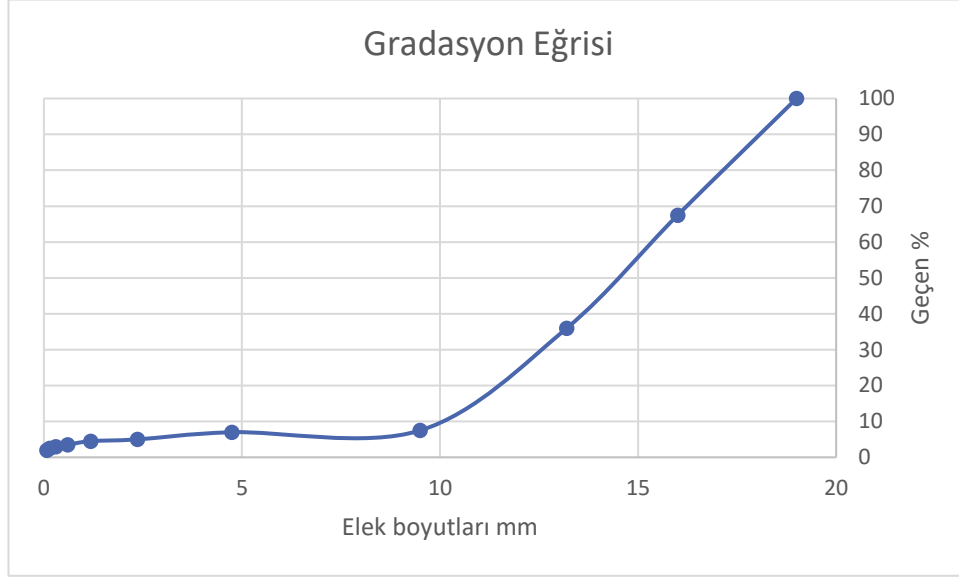
Şekil 3.19. Poroz asfaltın gradasyon eğrisi (Guluyev 2022)
