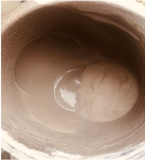
Şekil 3.12. Harcın segregasyon hali
