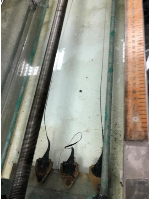
Şekil 3.10. Düktilite deneyi, bitümün koptuğu an
