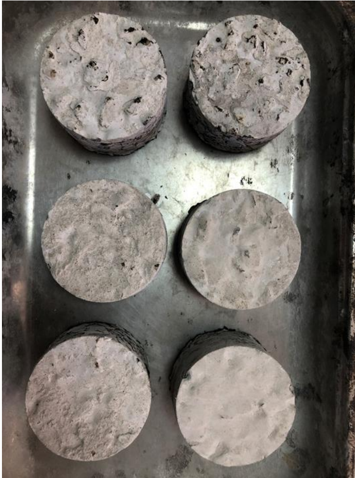
Şekil 3.25. Donma çözülme deneyi numuneleri
