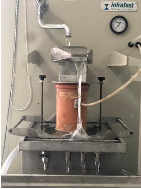
Şekil 3.26. Düşey permeabilite deneyi
