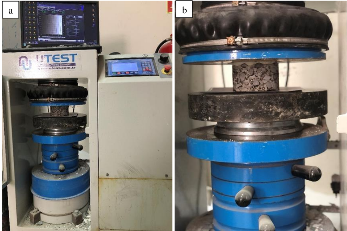
Şekil 3.24. Basınç dayanımı deneyi; a) Yük uygulanmadan önce; b) Yük uygulandıktan sonra
