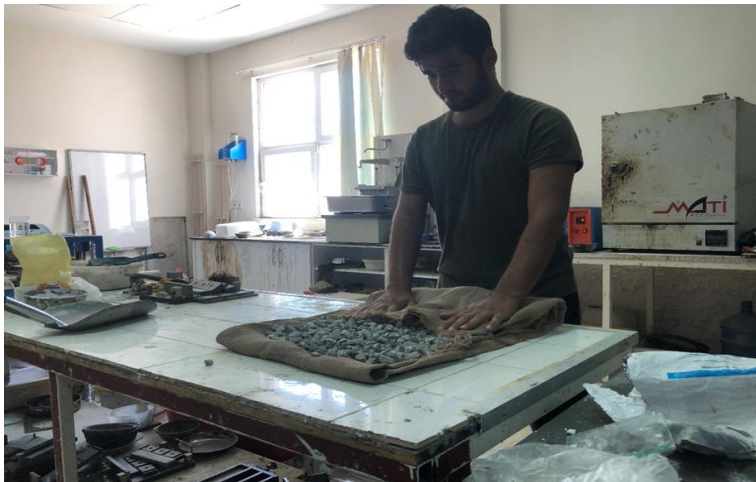
Şekil 3.4. İri agreganın kurutulması ve hazırlanması
