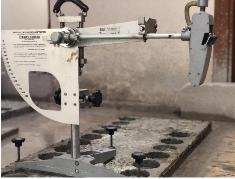
Şekil 3.28. Yüzey pürüzlülüğü deneyi
