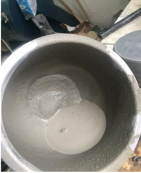
Şekil 3.1. Harçta oluşan segregasyon
