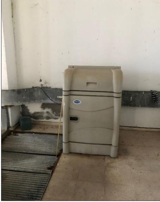
Şekil 2.6. LAAT Deşarj Noktasında bulunan kompozit numune alma cihazı
