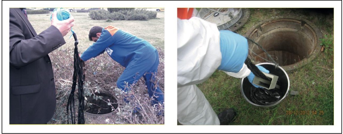
Şekil 2.1. Söz konusu çalışmada kullanılan biyofilm örnekleyci ahtapot (Bedük vd., 2021)
