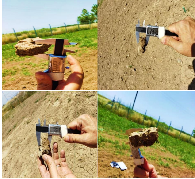
Şekil 3.8. Kaymak tabakası kalınlığı ölçümleri
