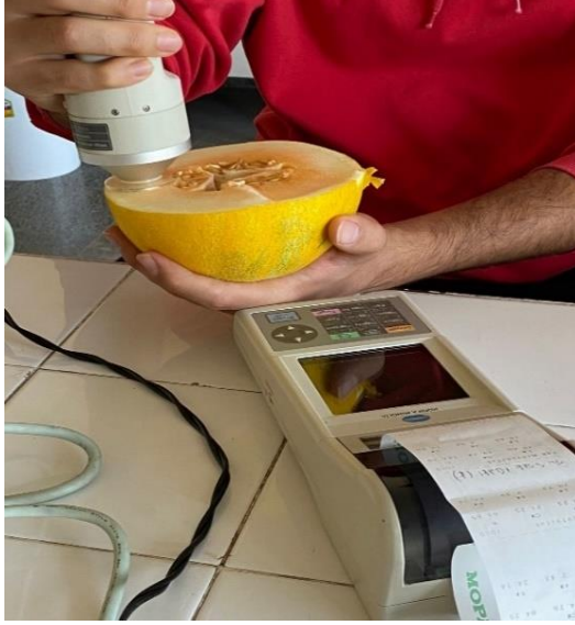
Şekil 3. 8. Meyve et rengi ölçümü
