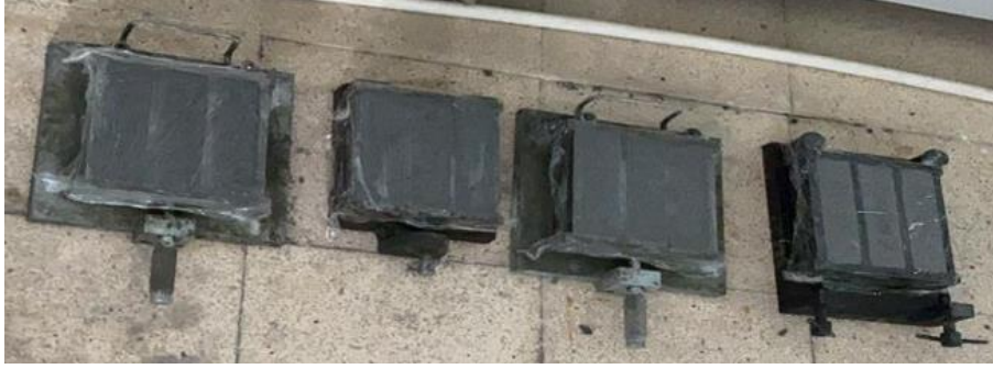
Şekil 3.5. Harçların kalıplara yerleştirilmesi
