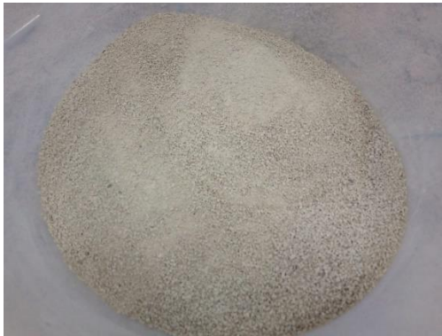
Şekil 3.2. Çalışmada kullanılan kırma kum agregatı
