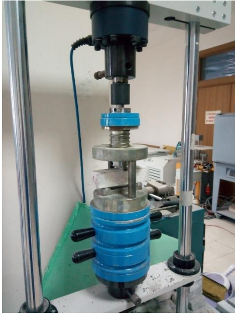
Şekil 3.9. UTEST cihazı ile eğilme dayanımı tayini
