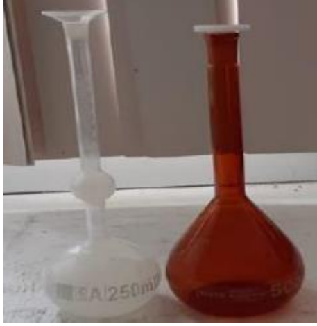
Şekil 3.3. Le Chatelier balonu ve balon Joje
