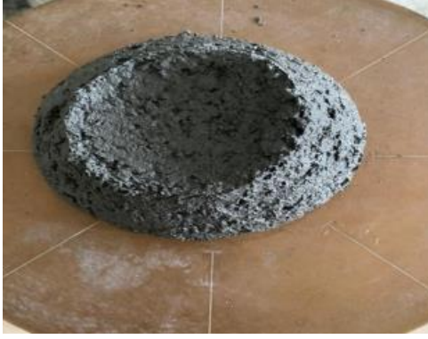
Şekil 3.7. Taze harç kıvam deneyi
