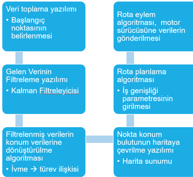
Şekil 3.15. Ön kurulum yazılımı iş akış algoritması
