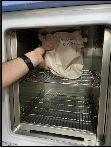
Şekil 3.4. Bitki kuru ağırlıklarının belirlenmesi için örneklerin kese kağıtlarında etüve koyulması
