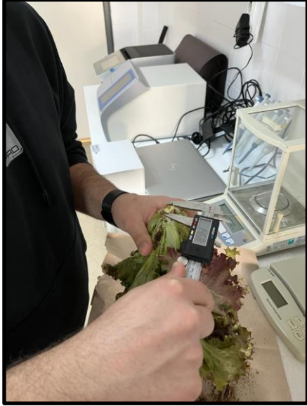
Şekil 3.6. Bitki de kök boğazı çap ölçümü
