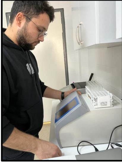
Şekil 3.16. C vitamini analizi için alınan örneklerin spektrofotometrede okunması
