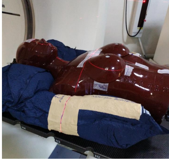
Şekil 3.12. Rando fantomun supin pozisyonda BT çekimi
