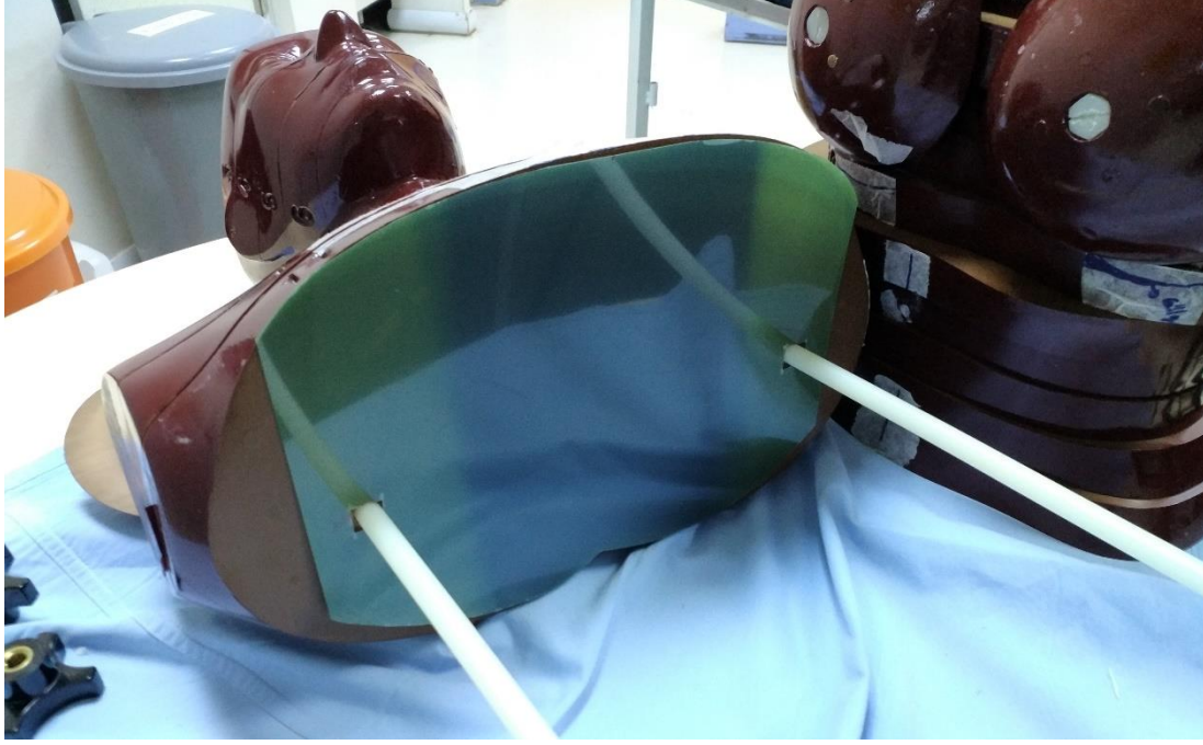
Şekil 3.17. EBT3 gafkromik filmlerin fantomun 14. ve 15. kesit aralığına yerleştirilmesi.
