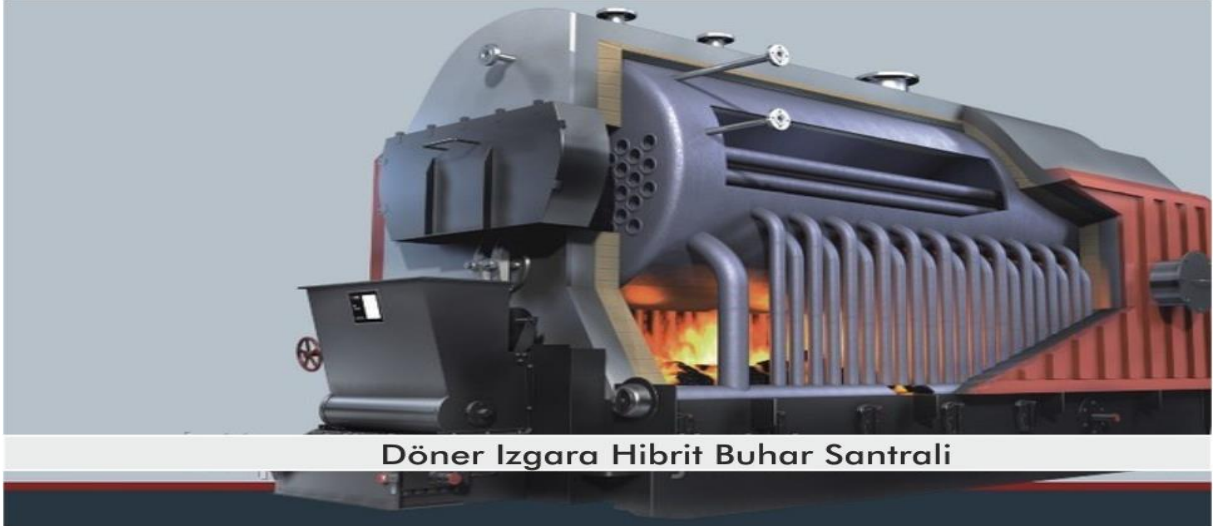
Şekil 2.1 Döner Izgara Hibrit Buhar Santrali
