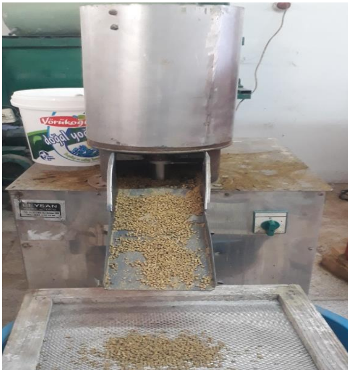
Şekil 3.3. Deneme yemlerinin pelet makinesinde peletlenmesi
