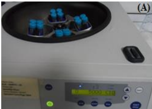
Şekil 7.3. Bitki örneklerinden hazırlanmış çözeltinin santrifüj uygulanmasından (A) sonra süpernatant 0.45 µm'lik bir şırınga filtresinden geçirilmesi (B) (Orijinal)
