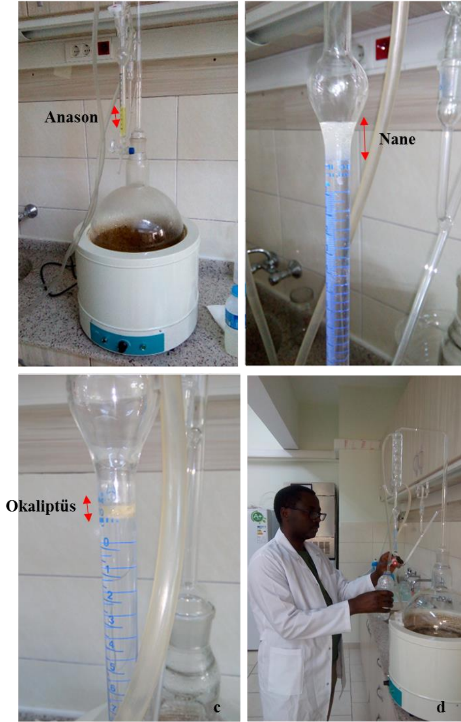
Şekil 3.4. Neo-clavenger cihazında anason (a), nane (b) ve ökaliptus (c) uçucu yağlarının ekstraksiyonu ve toplanması (d).
