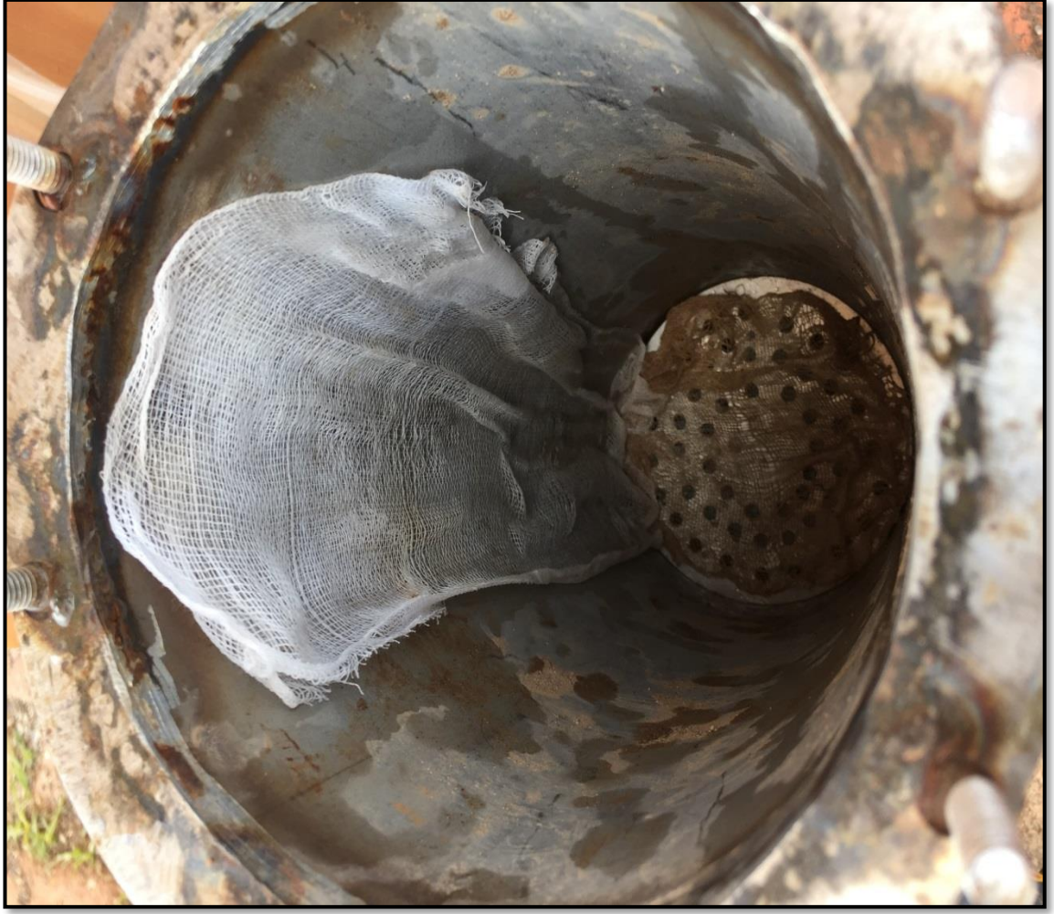
Şekil 3.3. Permeametre düzeneğine toprak zerrelere girişinin önlenmesi
