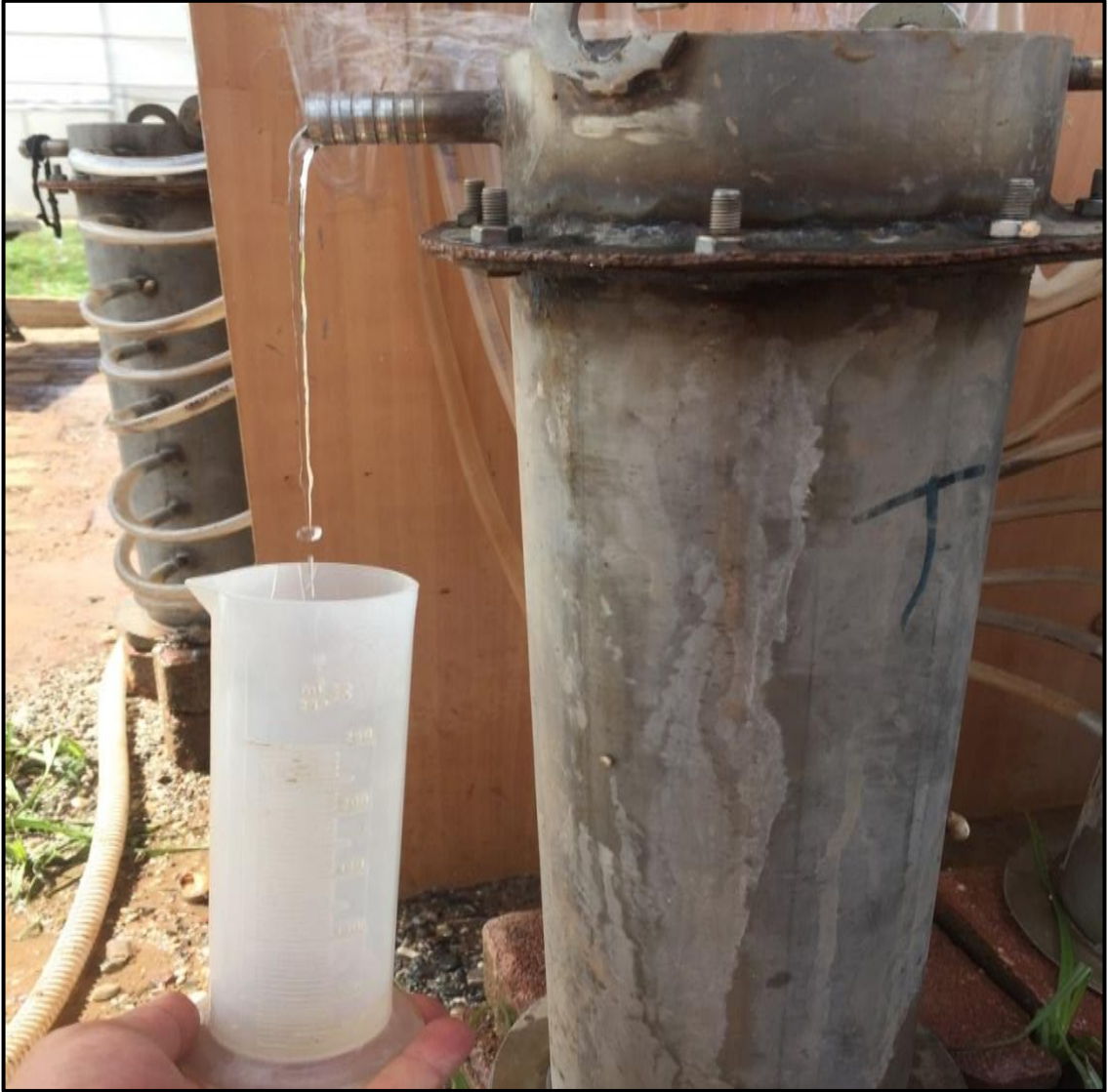
Şekil 3.7. Ölçülü kap yardımı ile debi ölçümünün yapılması
