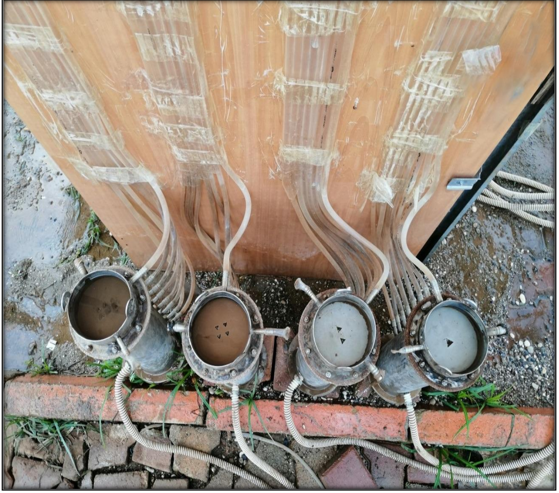
Şekil 3.4. Permeametre düzeneğinde flanşlı vidalı sistemin üstten görünümü
