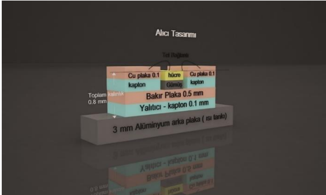
Şekil 3.4. Yoğunlaştırıcı modül içerisinde güneş hücresi ve alıcı tasarımının şematik olarak gösterimi
