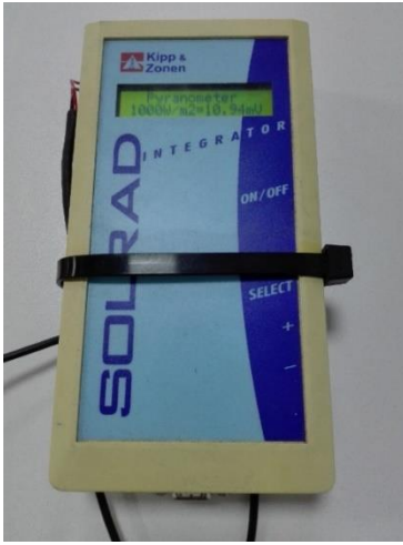
Şekil 3.15. Piranometre için Kipp&Zonen markalı veri kaydedici
