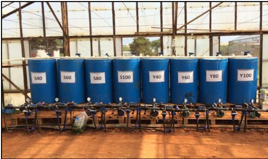
Şekil 3.3. Damla sulama sistemi kontrol birimi
