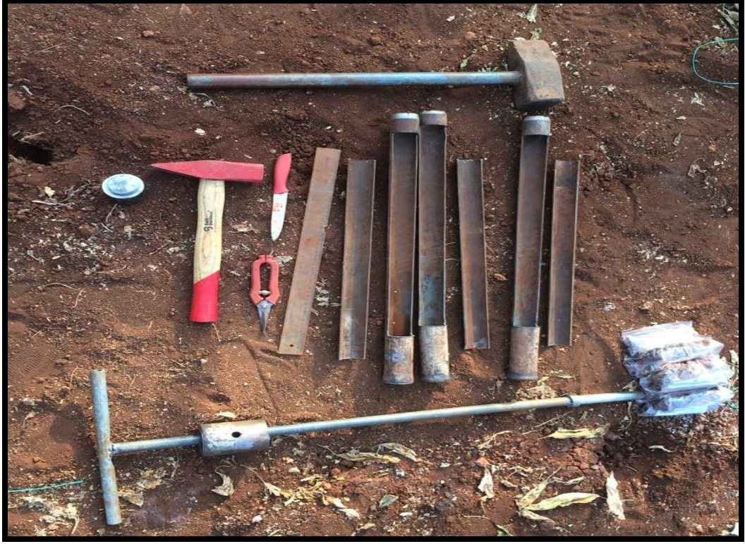
Şekil 3.10. Kök örneklemesinde kullanılan aletler
