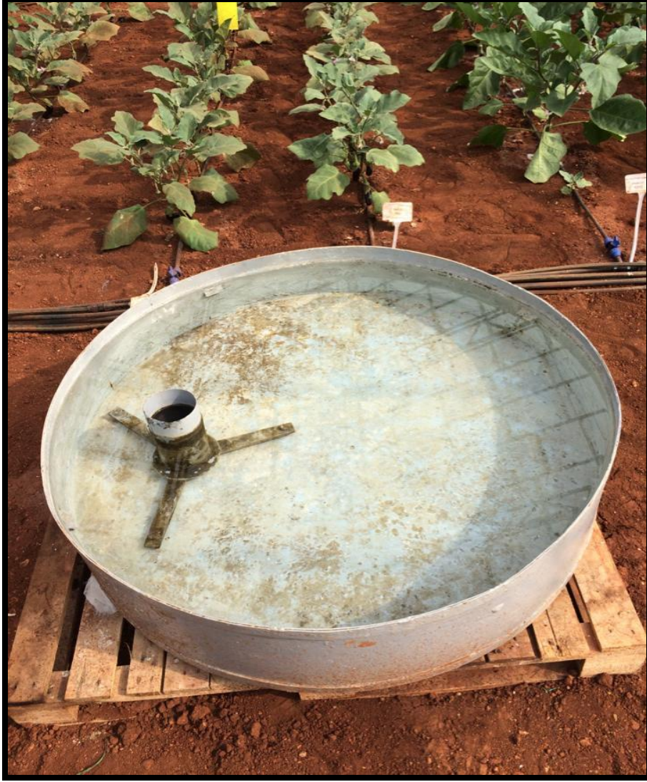
Şekil 3.9. Sera içindeki A-Sınıfı Buharlaşma Kabı'na ait bir görünüm
