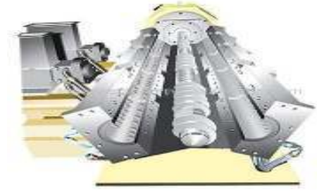
Şekil 2.5. Ekstrüzyon işleminde kullanılan tek vidalı ekstrüder
