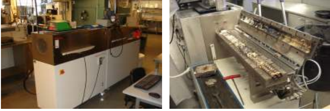
Şekil 3.1. Araştırmada kullanılan ekstrüder cihazı ve ekstrüzyondan sonraki durumu
