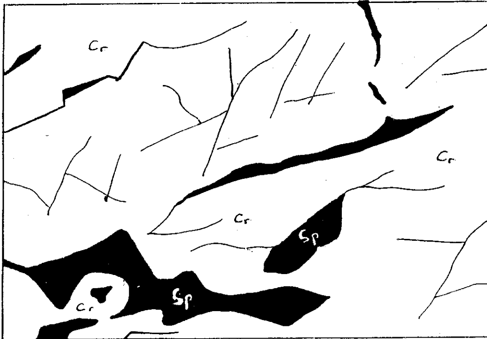
Foto-11: Masif kromit (Cr) içinde çatlak ve araları dolduran serpantin (sp) (Yavşanlı ocak).
