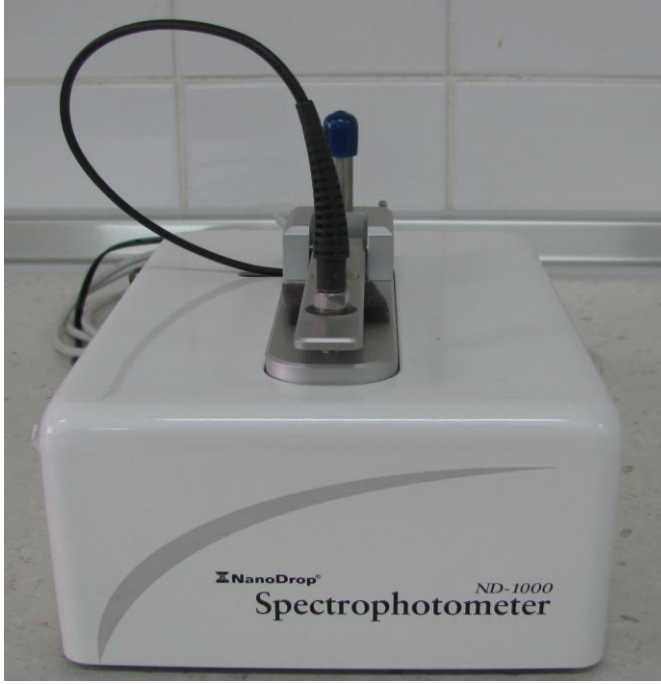
Şekil 3.1. DNA miktar tespitinde kullanılan spektrofotometre cihazı (A.Ü.Z.F. Bitki Koruma Bölümü Moleküler Bitki Bakteriyolojisi Laboratuvarı)
