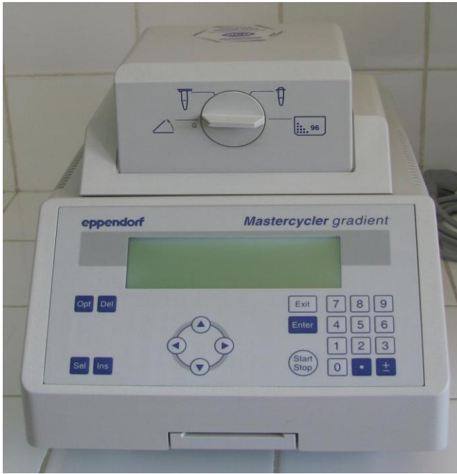
Şekil 3.2. Eppendorf Master Gradient Thermal Cycler PCR cihazı (A.Ü.Z.F. Zootekni Bölümü Moleküler Genetik Laboratuvarı)
