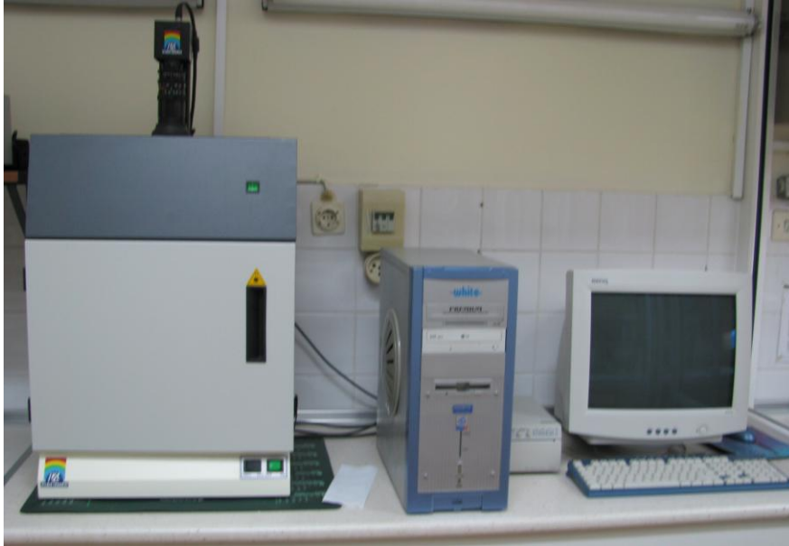
Şekil 3.6. Jel görüntüleme donanımı (A.Ü.Z.F. Bitki Koruma Bölümü Moleküler Bitki Bakteriyolojisi Laboratuvarı)
