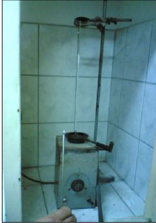
Şekil 3.7. Parlama Noktası Deney Düzenegi
