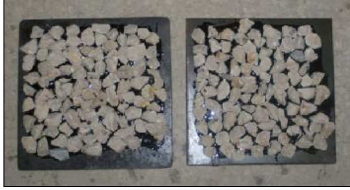
Şekil 3.10. Mekanik Sericiden Çıkarılan Deney Levhası
