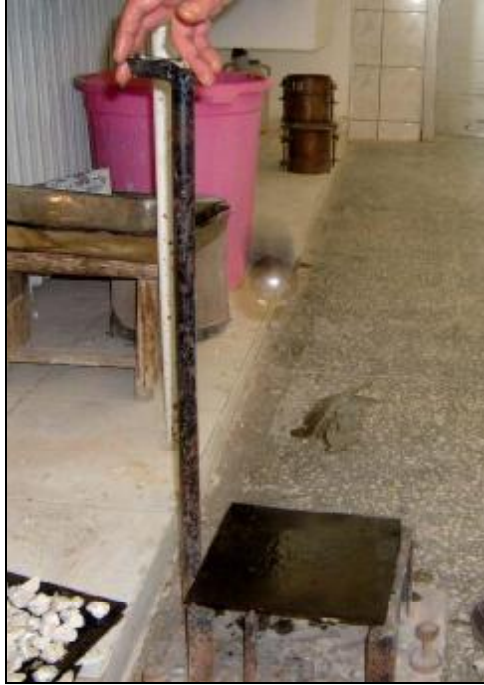
Şekil 3.12. Yapışma Deneyi Düzenegi
