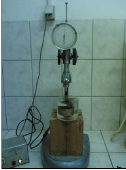
Şekil 3.4 Penetrasyon Deneyi Düzenegi
