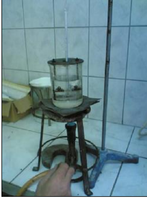
Şekil 3.6. Yumuşama Noktası Deneyi Düzenegi
