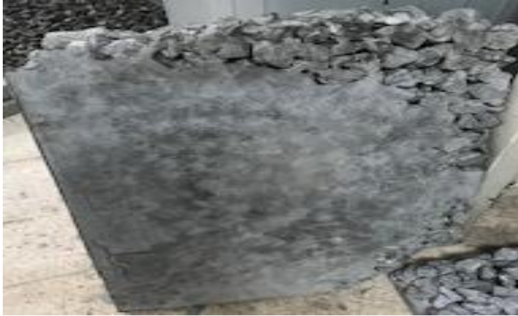
Şekil 4.4. 2. Denemede elde edilen poroz beton numunesi
