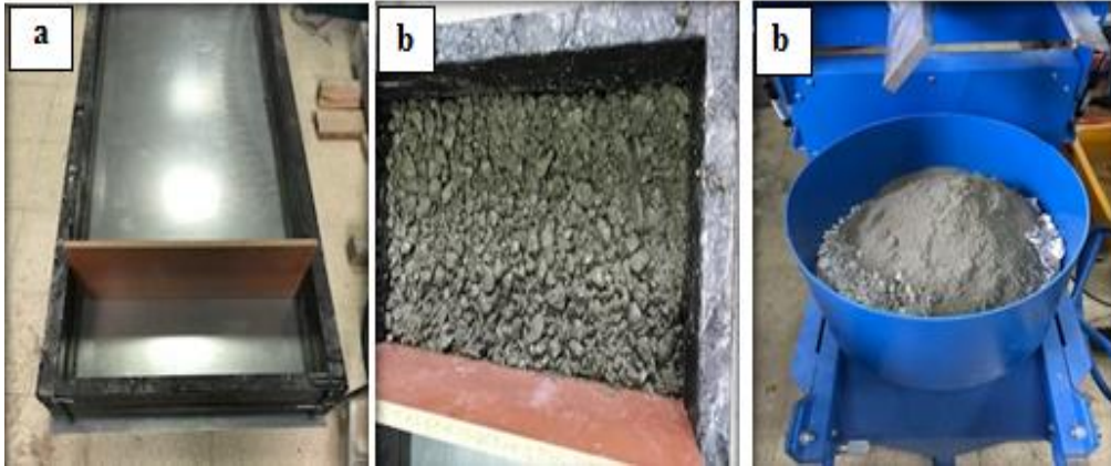
Şekil 3. 11. a) Beton kalıbı; b) Beton mikseri; c) Kalıba dökülen beton numunesi
