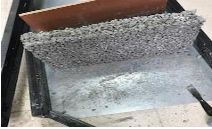
Şekil 4.6. Poroz betonun kalıptan çıkarılması
