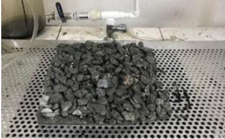
Şekil 4.3. 1. Denemede elde edilen poroz beton numunesi
