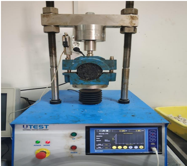
Şekil 3. 18. Marshall stabilite deney cihazına numunenin yerleştirilmesi
