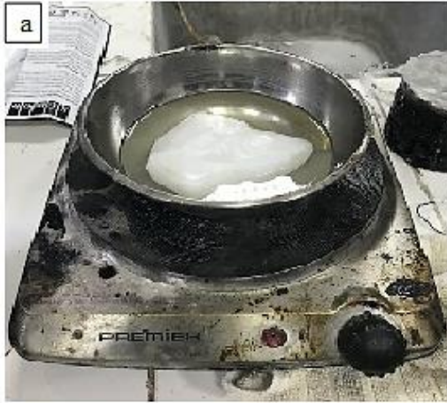
Şekil 3. 22. a) Deneyde kullanılacak parafinin ocakta eritilmesi; b) Numunenin alt tabakasının parafin ile kaplanması
