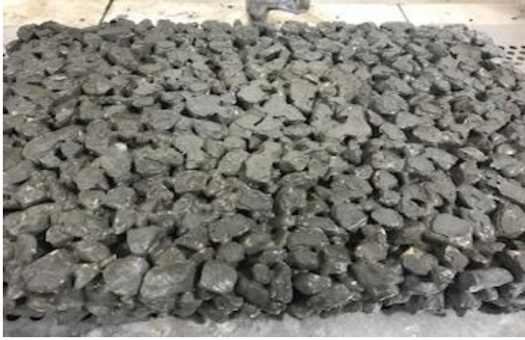
Şekil 4.5. 3. Denemede elde edilen poroz beton numunesi
