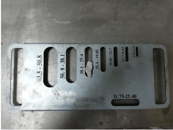
Şekil 3. 5. Yassılık indeksi deney şablonu
