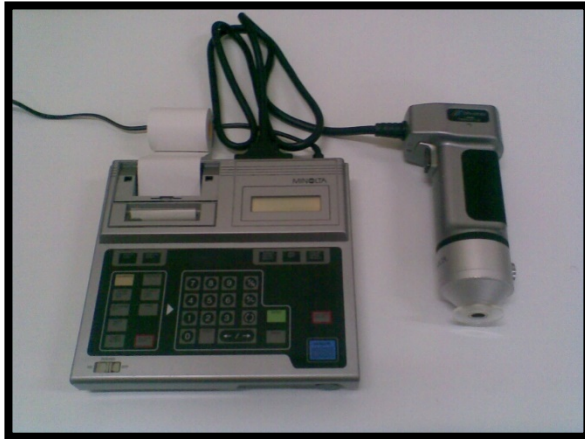
Şekil 3.11. Minolta CR-200 renk kromometresi
