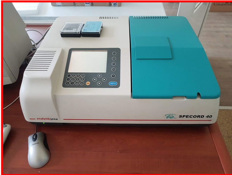
Şekil 3.17. Analytic Jena AG Specord 40 spektrofotometre cihazı
