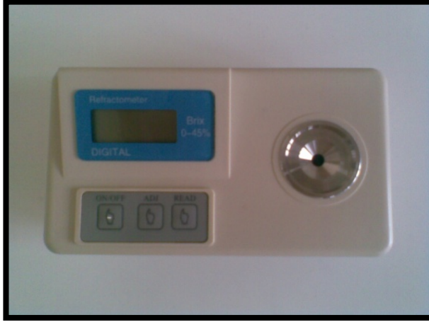
Şekil 3.10. SÇKM ölçümleri için kullanılan dijital refraktometre
