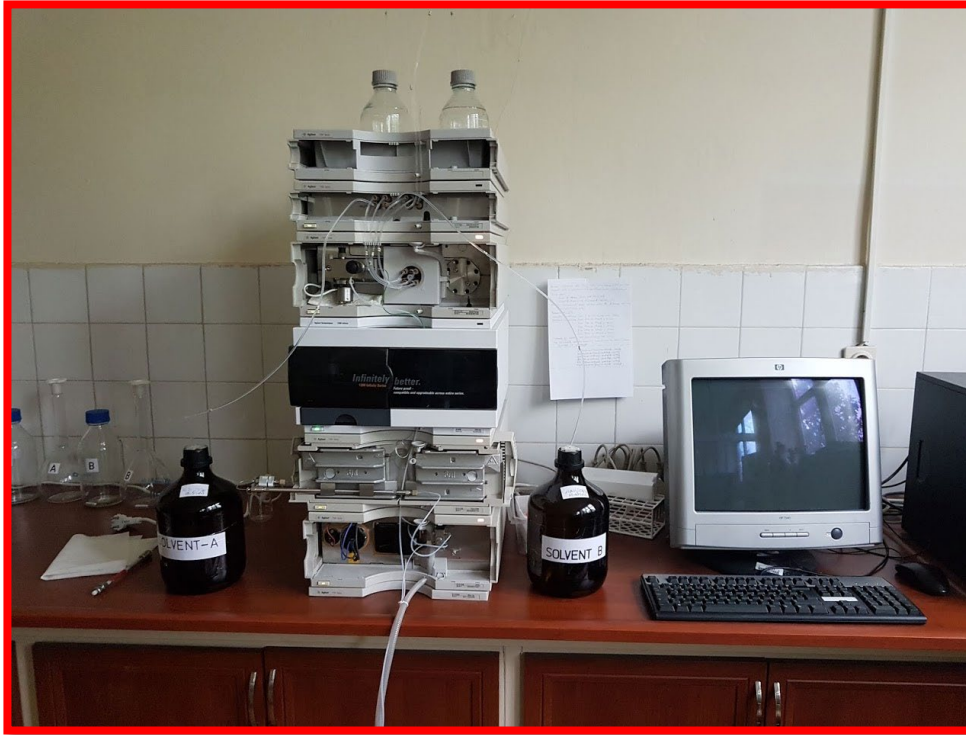
Şekil 3.14. AGILENT 1100 Series HPLC cihazı
