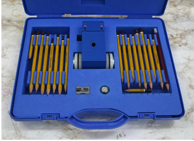
Şekil 4.30. Erichsen marka Scratch Hardness Tester Model 291 kalem sertlik testi aparatı
