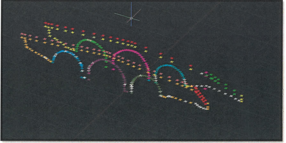
Şekil 4.17. Auto-CAD 3D'ye aktarılan koordinatlı noktaların perspektif görünüşü
