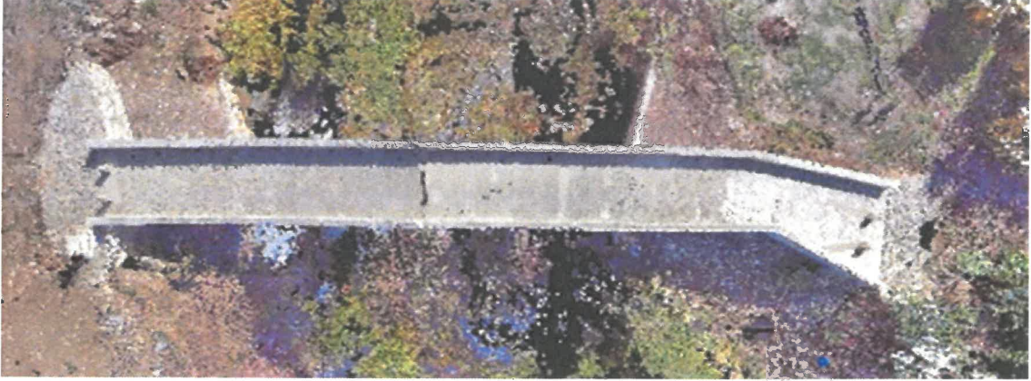
Şekil 4.13. Köprü restorasyon sonrası yersel lazer tarama yoluyla edinilen kuş bakışı nokta bulutu dosyası
