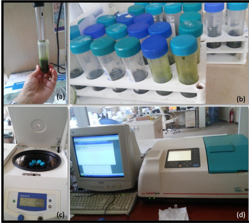
Şekil 3.7. Spektrofotometrede klorofil analizlerinin yapım aşamaları a) yaprak püresinin homojenizasyonu b) örneklerin aseton ile 25 ml'e tamamlanması c) örneklerin santrifüj edilmesi d) süzüntülerin absorbanlarının spektrofotometrede okutulması
