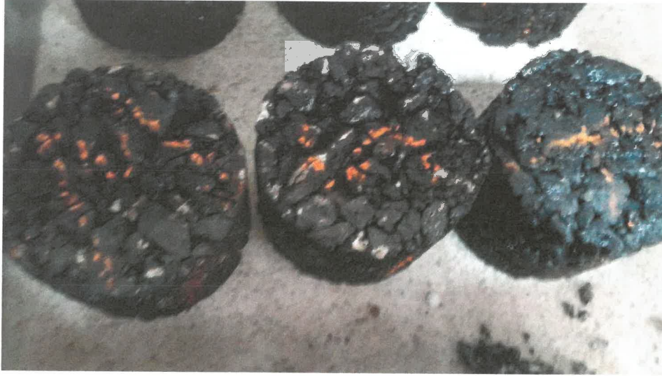
Şekil 4.4. İkinci karışım formülüyle hazırlanan Marshall numuneleri
