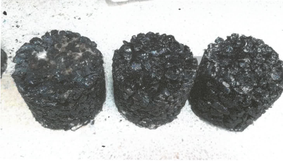
Şekil 4.5. Üçüncü karışım formülüyle hazırlanan Marshall numuneleri
