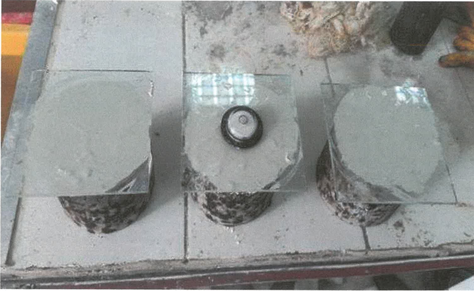
Şekil 3.18. Kalker bileşiğiyle kaplanmış Marshall numuneleri
