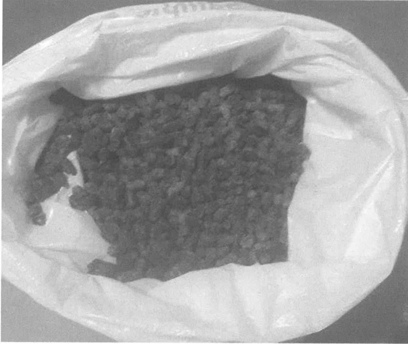
Şekil 3.12. Poroz asfalta kullanılan fiber
