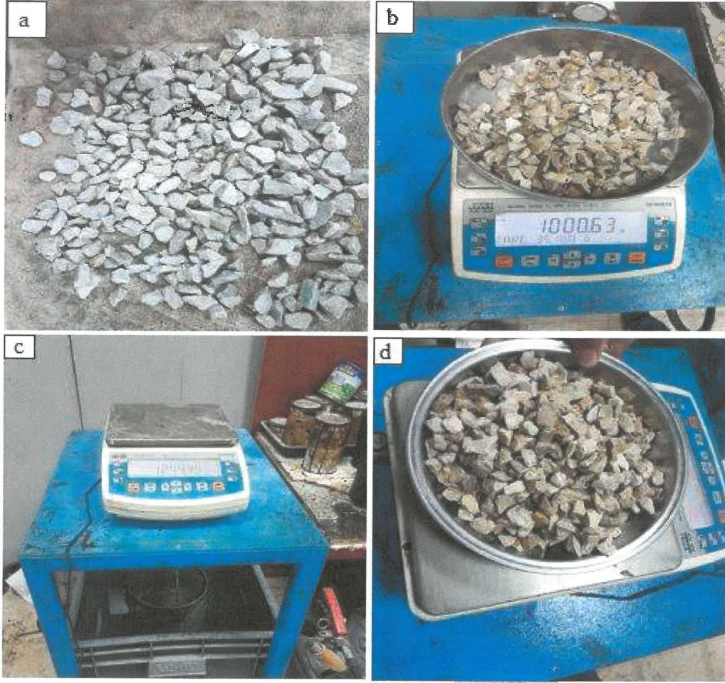
Şekil 3.3. Kaba agrega özgül ağırlığı; a) suda 24 saat sonra agrega numuneleri; b) doymuş agrega ağırlığı; c) suda agrega ağırlığı; d) kuru agrega ağırlığı
