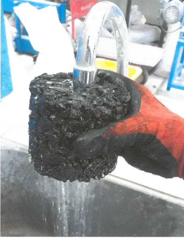
Şekil 4.6. % 27.7 boşluklu olan Marshall numunesi
