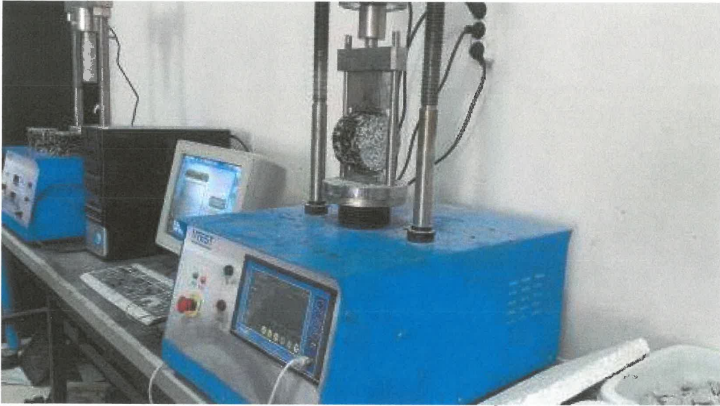
Şekil 3.16. İndirekt çekme deneyi
