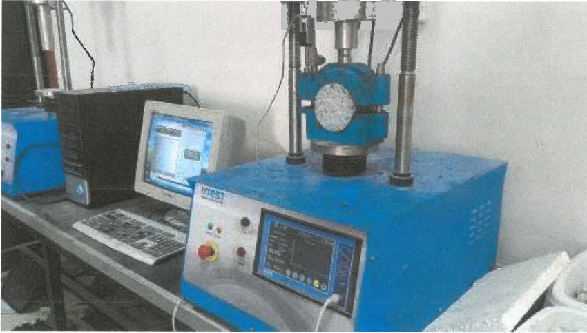
Şekil 3.15. Marshall stabilite deneyi
