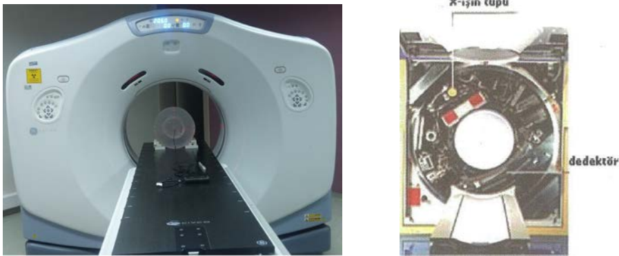
Şekil 2.10. Gantry'nin dıştan (AEAH 2019) ve ön kapağı açılarak iç yapısı görülmektedir (Baykal ve Oyar 2003)
