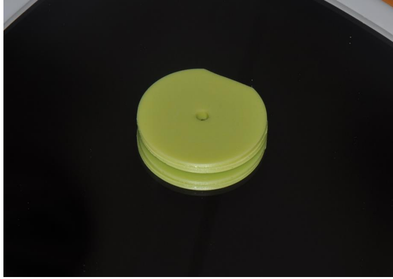
Şekil 3.19. Şemaya göre oluşturulmuş silikon kalıp. Bu kalıp blok yapımı sırasında yıprandığında kolayca yeniden üretilebilmektedir
