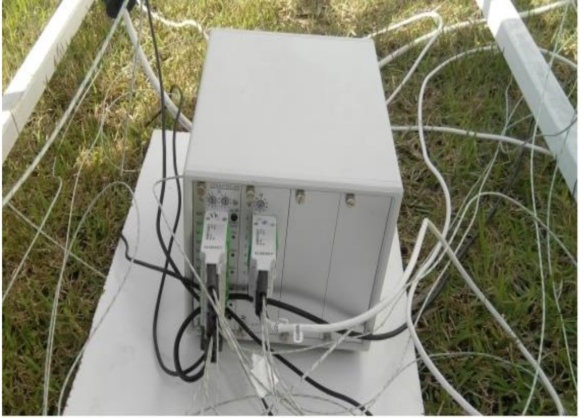
Şekil 3.27. Sıcaklık ölçümleri için kullanılan veri toplama cihazına ait görüntü
