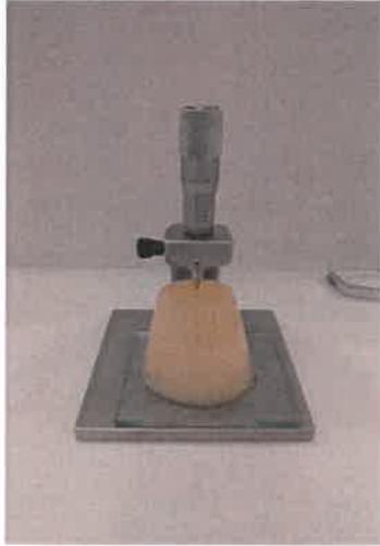
Şekil 3.8. Ridgelimetre cihazında SAG değeri ölçümü
