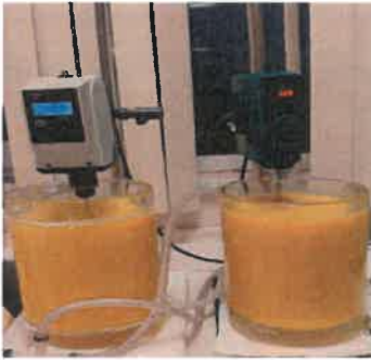
Şekil 3.1. Çift cidarlı ısıtmalı reaktörde pektin ekstraksiyonu
