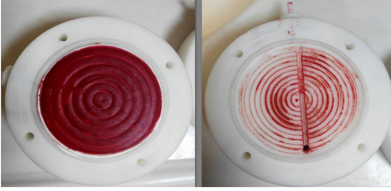
Şekil 3.10. Filtrasyon sonrası teflon düzeneğinin iç yapısı ve içine yerleştirilen filtrenin son hali
