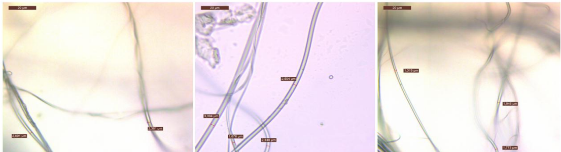
Şekil 4.7. Hava basıncı ve akış hızı sabit tutulduğunda sıcaklık artırılması ile elde edilen bazı liflerin mikroskop görüntüleri
