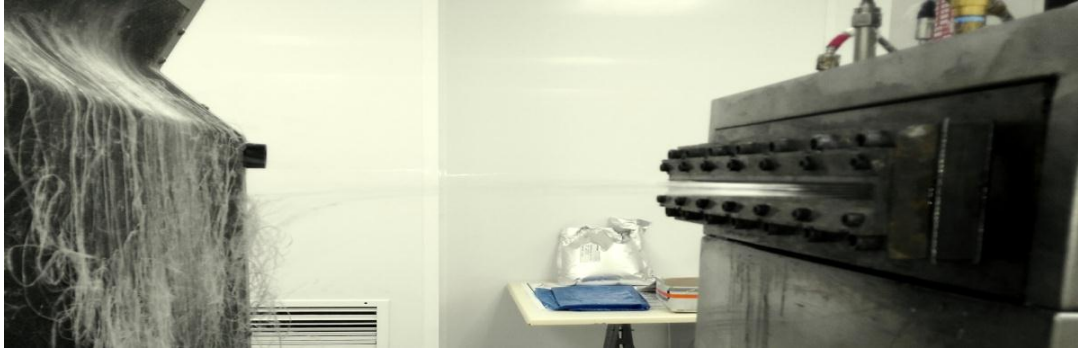
Şekil 3.4. Melt blown cihazındaki die burun bölgesi
