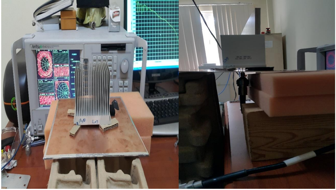
Şekil 3.7. S11 parametresi ölçümü VNA ve soğutucu ölçüm düzeneği
