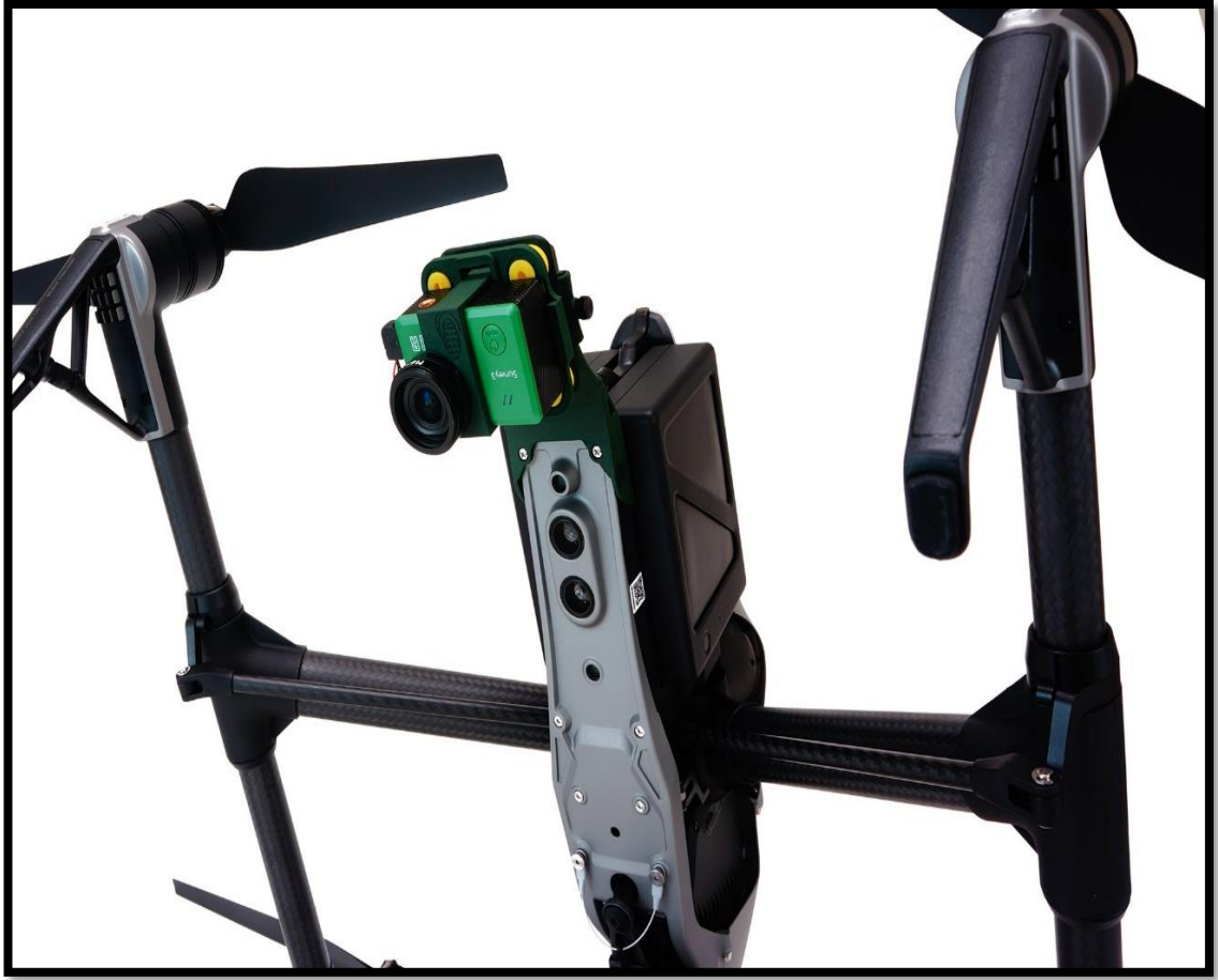
Şekil 3.6. Inspire 2'ye monte edilmiş survey 3 kamera
