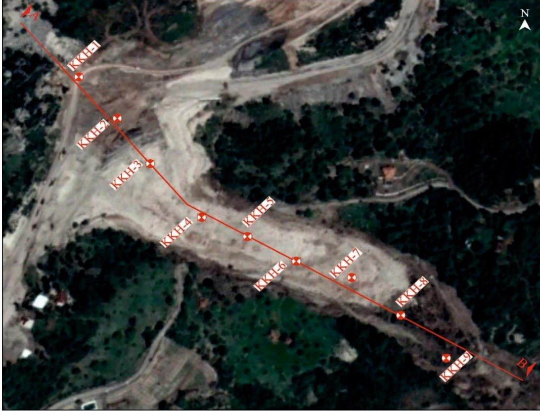
Şekil 4.14. Heyelan üzerinde uygulanan sondaj çalışmaları
