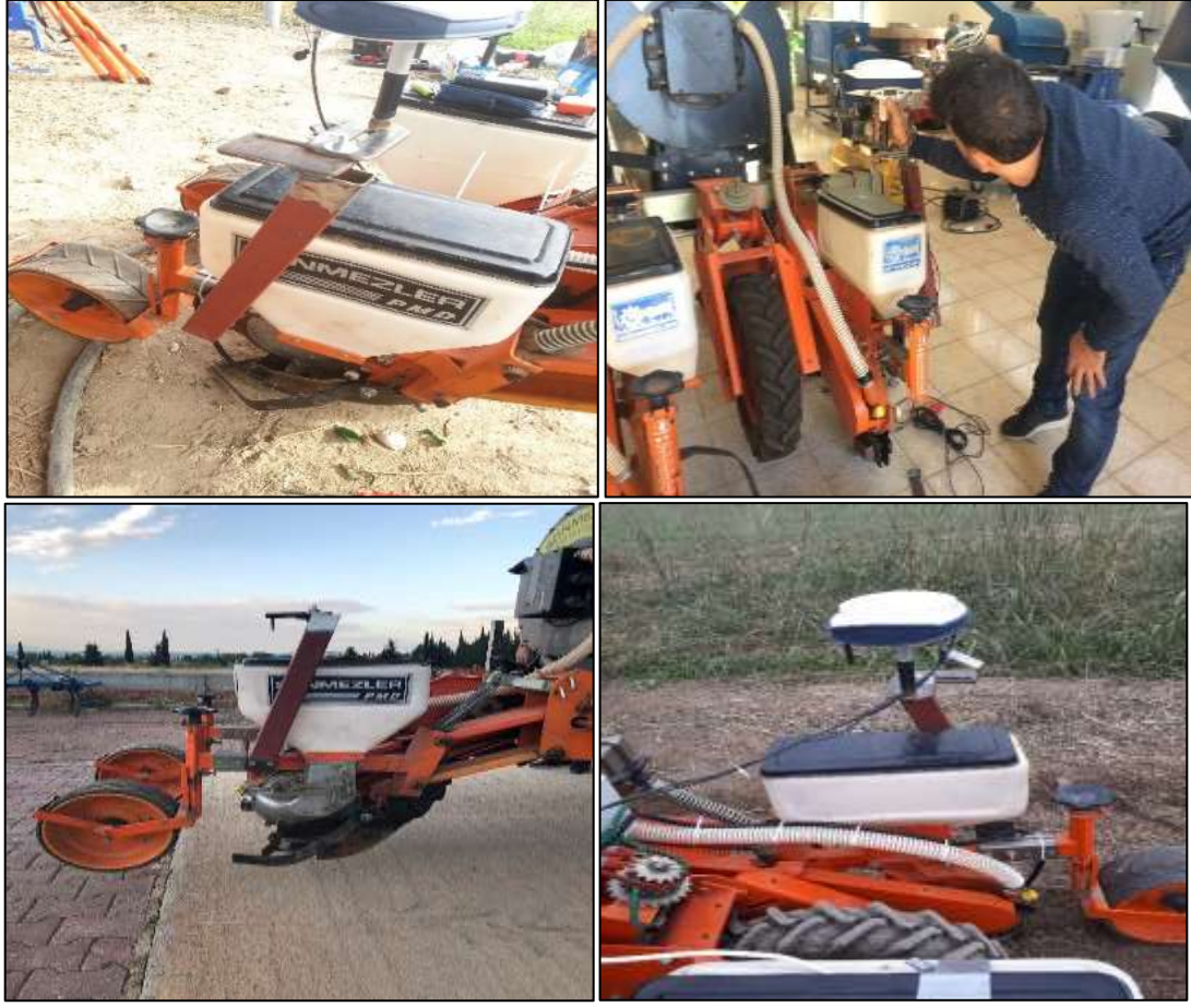
Şekil 3.11. RTK-GPS alıcısının pnömatik hassas ekim makinasına yerleştirilmesi
