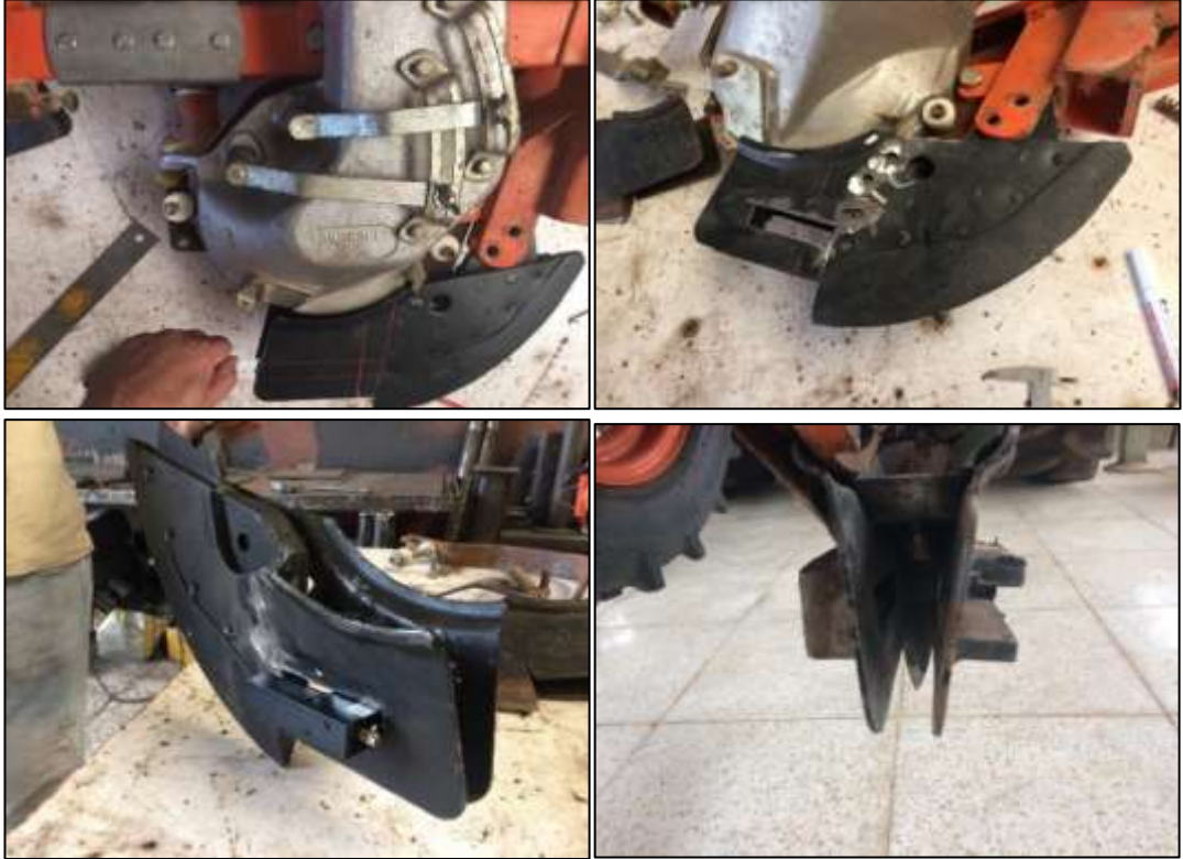
Şekil. 3.26. Balta tipi gömücü ayağına kızılötesi alan sensörünün yerleştirilmesi
