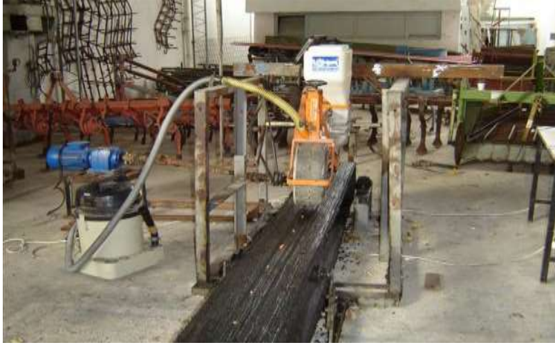
Şekil 2.4. Tohumlar arası mesafe ölçümünün yapıldığı yapışkan bant sistemi (Yiğit 2006)
