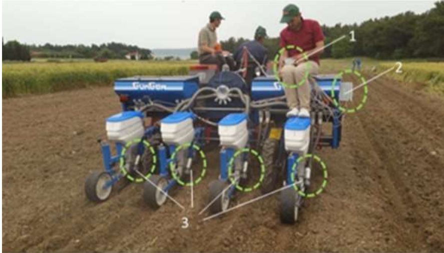
Şekil 2.17. Klasik tahrik sistemleri ile elektronik tahrik sistemini tarla denemesi (Çay vd. 2018)
