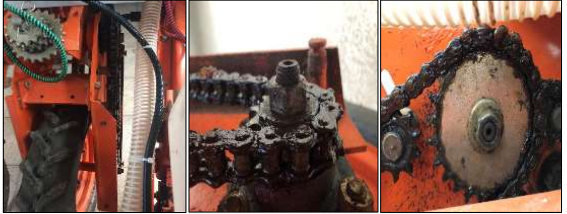
Şekil 3.16. Z_1 ve Z_2 dişlilerinin hareket iletimi
