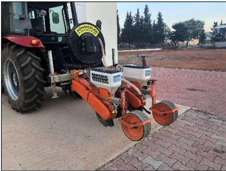
Şekil 3.15. Sönmezler PM-01 model hassas ekim makinası
