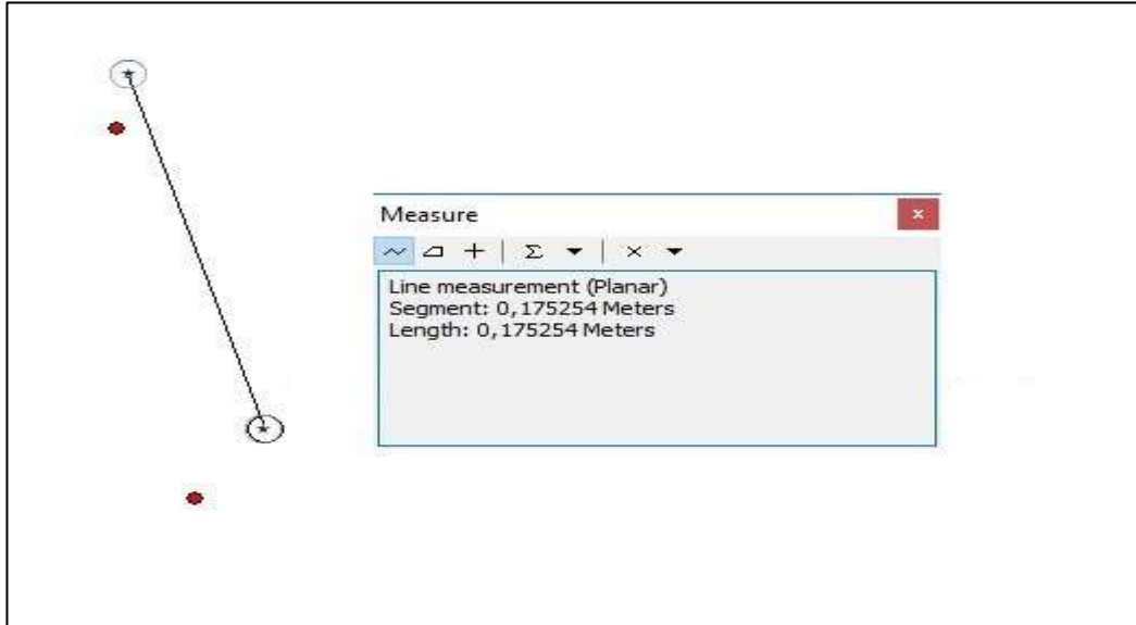
Şekil 4.7. 1 m/s ilerleme hızında tohum algılama sistemi ile gerçek bitki konumları arası uzaklık
