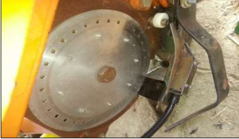
Şekil 3.17. Ekici düzen (32 delikli plaka)
