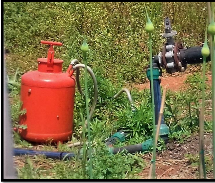
Şekil 3.8. Yetiştirme alanının gübrelemede kullanılan gübreleme ünitesi
