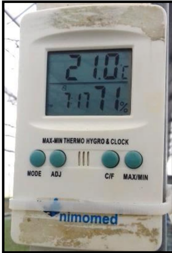
Şekil 3.7. Serada nem ve sıcaklık değerleri ölçen alet
