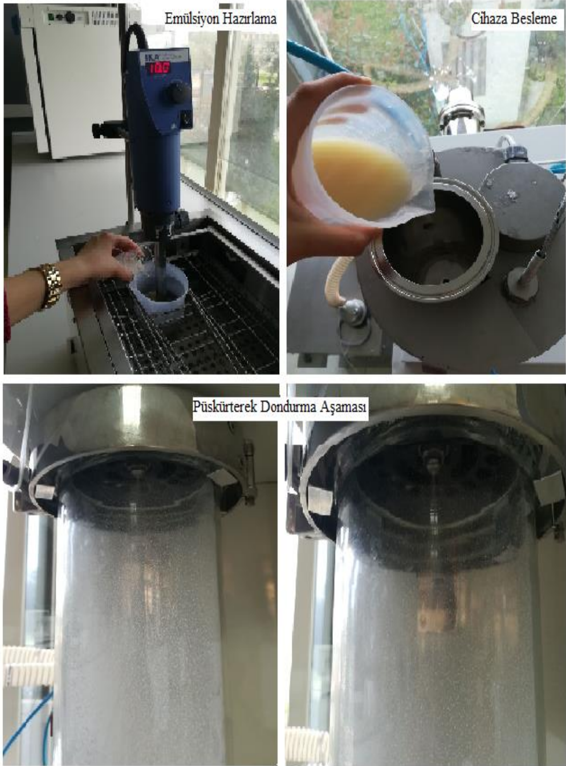
Şekil 3.2. Püskürterek soğutma cihazı ile kapsaisin mikroenkapsülasyonu aşamaları
