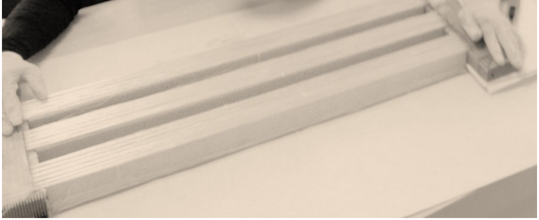
Şekil 3.6. Liflerin kılavuzlar vasıtasıyla yerleştirilmesi
