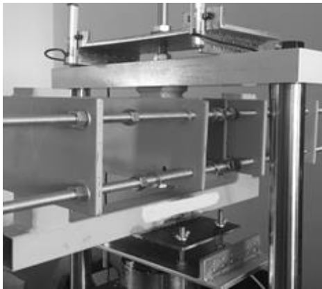
Őekil 3.2. Modifiye edilmiř 3 ray kayma testi dzeneđi (Sargın 2018)
