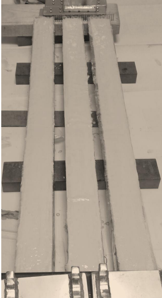
Şekil 3.7. Numune üzerine poliüretan sürülmesi
