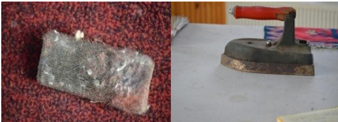
Fotoğraf -62 Tuba Ayhan, Tesviye İşleminde Kullanılan Tel Fırça ve Ütü, 2018.
