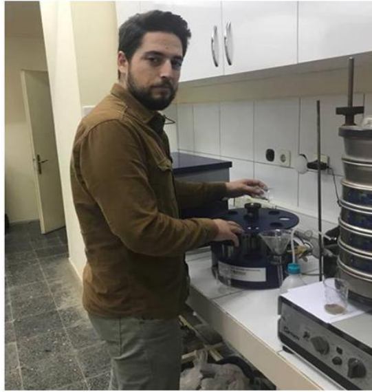
Şekil 3.6. Agregat stabilitesi analiz yapılışından bir görünüm
