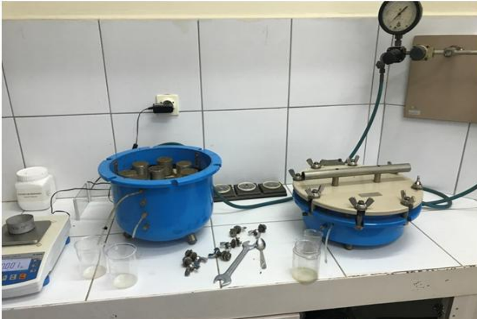
Şekil 3.4. Toprakların tarla kapasitesi ve solma noktası analizlerinin yapıldığı basınçlı levha ve basınçlı membran aletlerinin bir görünümü
