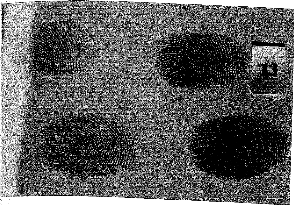
Resim 14: F tekniği ile beyaz fotokopi kağıdı üzerine alınan ve 2NS ile iyi seviyede görünür hale getirilen bir yıllık latent izlerin görünümü. Aynı donörden sırasıyla sağ alt birinci, sağ üst ikinci, sol alt üçüncü ve sol üst dördüncü olarak alınan latent parmak izleridir. Nemin yoğunluğuna bağlı ilk alınan izde detay boyanması bariz iken diğerlerinde azalmaktadır.
