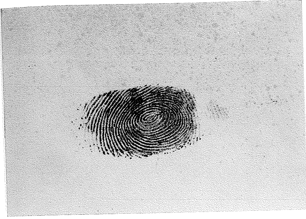
Resim 4: F tekniđi uygulanarak beyaz fotokopi kađıdı üzerine alınan ve 2NS ile papil hatları belirgin olarak iyi derecede görünür hale getirilen latent parmak izinin görünümü.
