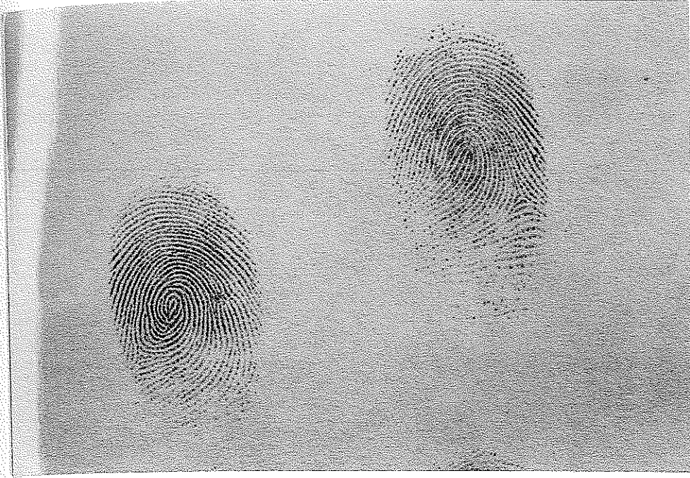
Resim 2: C tekniđi uygulanarak beyaz fotokopi kađı üzerine alınan ve INS ile iyi derecede grnr hale getirilen latent parmak izleri ve kađıt zerinde meydana gelen sararmanın grnm.
