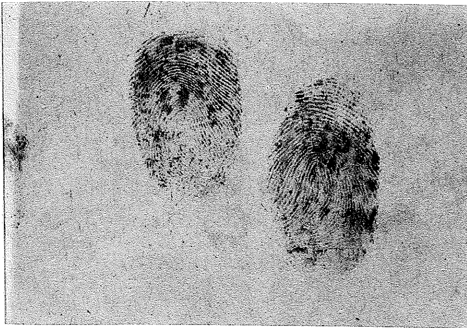
Resim 3: D tekniđi uygulanarak teksir kađı üzerine alınan ve INS ile orta derecede grnr hale getirilen latent parmak izlerinin grnm
