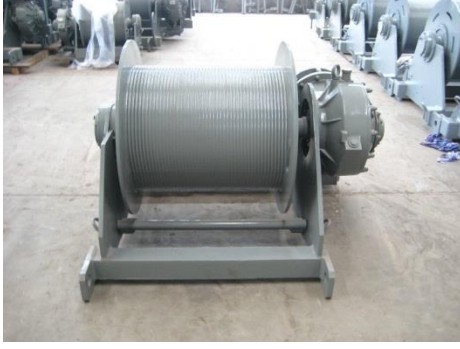
Şekil 2.34. Kule vinç halat tamburu örneği
