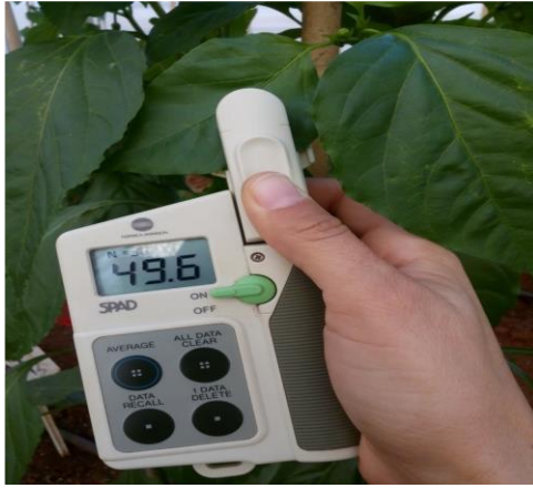
Şekil 3.5. SPAD-metre ile ölçüm yapımı
