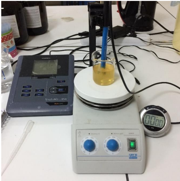
Şekil 3.2. MAP çöktürmesi deney düzeneği
