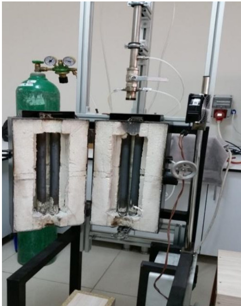
Şekil 3.4. Hızlı piroliz deney düzeneği
