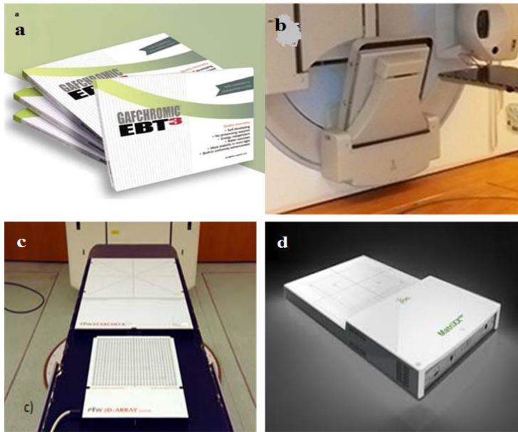
Şekil 2.26. 2D dozimetrik sistemler; a) Gafkromik EBT 3 film; b) EPID, c) PTW seven29; d) IBA I'mRT MatriXX (Elekta Ltd), (IBA Dosimetry).
