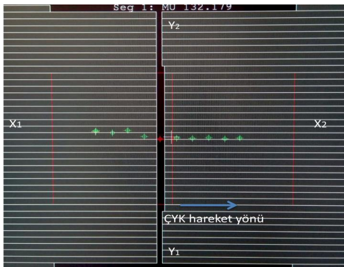
Şekil 3.16. Cross-plane penumbranın TPS'deki alan (3.alan) planı
