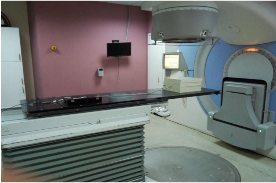
Őekil 3.24. Linak kalibrasyonu için output ölçüm düzeneęi (AEAHI 2018).
