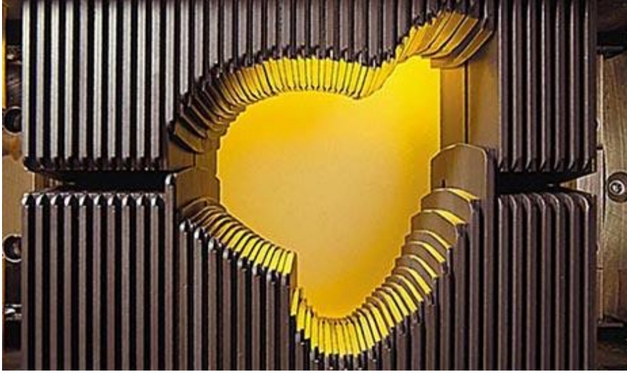
Şekil 2.14. Elekta ÇYK yapısı. 80 adet lif (yaprak) mevcuttur (Elekta Ltd).
