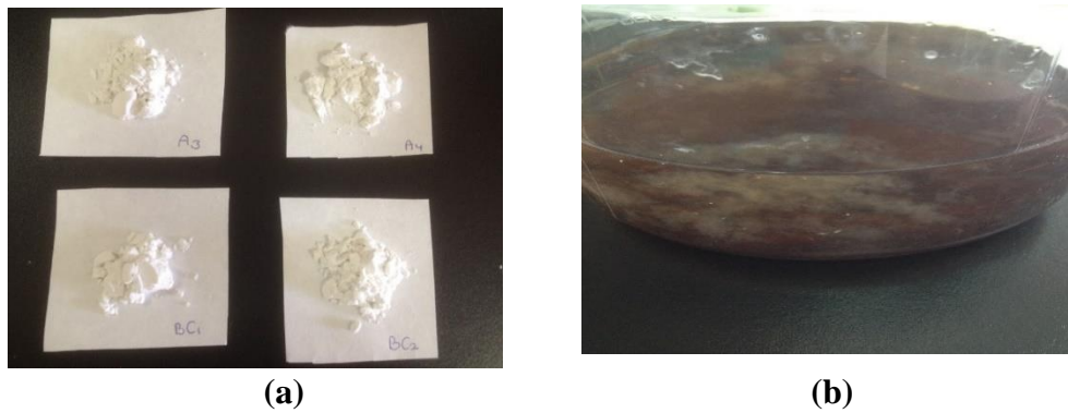
Şekil 4. 7. a) Filtrasyon işlemlerinde filtre yardımcı maddesi kizelgur; b) Toplam diyet lif analizinde etanol ile çöktürme.
