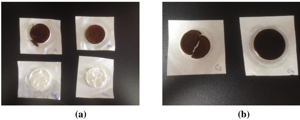
Şekil 4. 10. a) Filtrasyon işlemi tamamlandıktan sonra A1-A2 ( T. versicolor CCBAS614) %3 seviyesinde keçiyoynuzu içeren örnekler; b) Gece boyu 105 °C’de kurutulan ( T. versicolor CCBAS1399) %10 seviyesinde keçiyoynuzu içeren kalıntı örneklerin görüntüsü.
