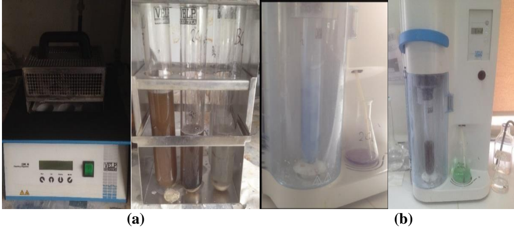
Şekil 4. 12. a) Protein yakma ünitesi; b) Protein distilasyon ünitesi görüntüsü.
