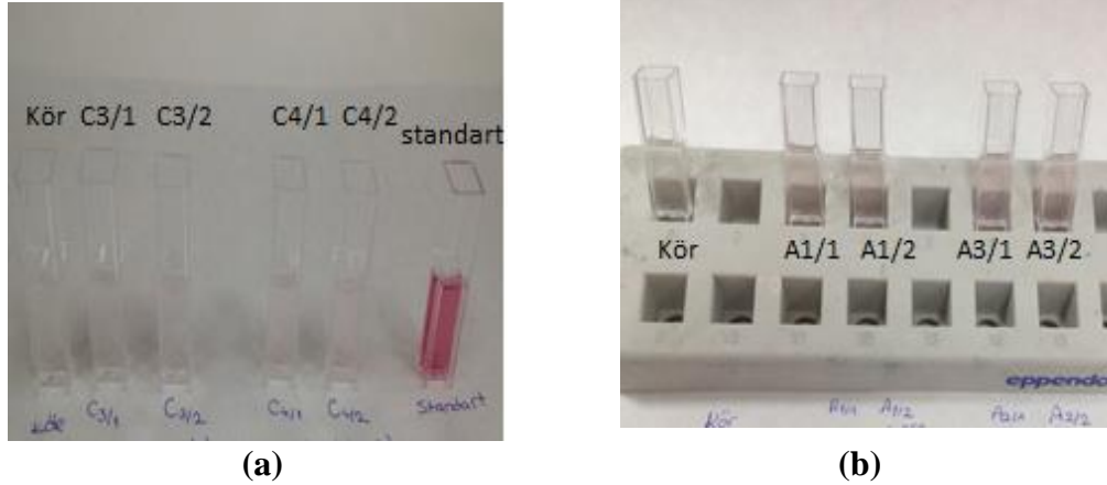
Şekil 4. 6. a) Kör, C3-C4 14 , T. versicolor CCBAS1399 %6 seviyesinde keçiyoynuzu posası içeren örneklerin toplam glukun miktarı görüntüsü (Pembe renk değişimi); b) A1 15 , T. versicolor CCBAS614 %3 seviyesinde keçiyoynuzu posası içeren örneklerin alfa glukun miktarı görüntüsü.
