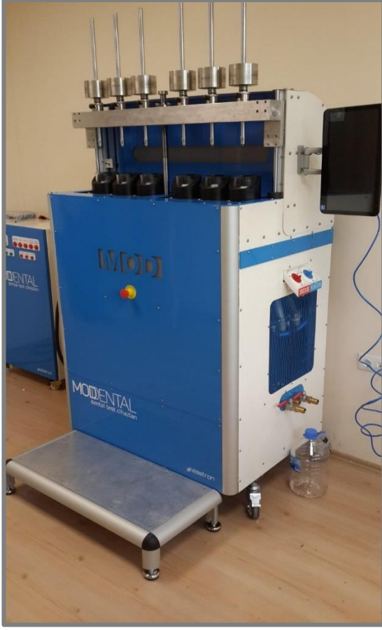
Şekil 3. 18. Termal siklus özelliği bulunan çiğneme simülatörü
