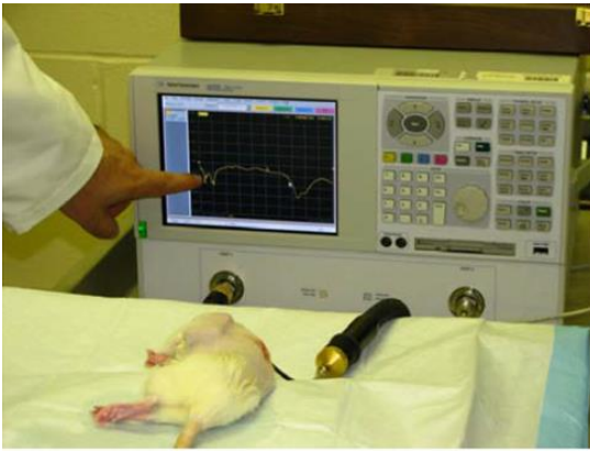
Şekil 3.16. Fare içerisinde implant anten ölçümü(Karaçolak, 2009)
