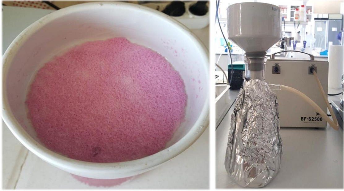
Şekil 3.3. Buchner hunisi ile 4-7 µm çaplı filtre kâğıdından süzme işlemi
