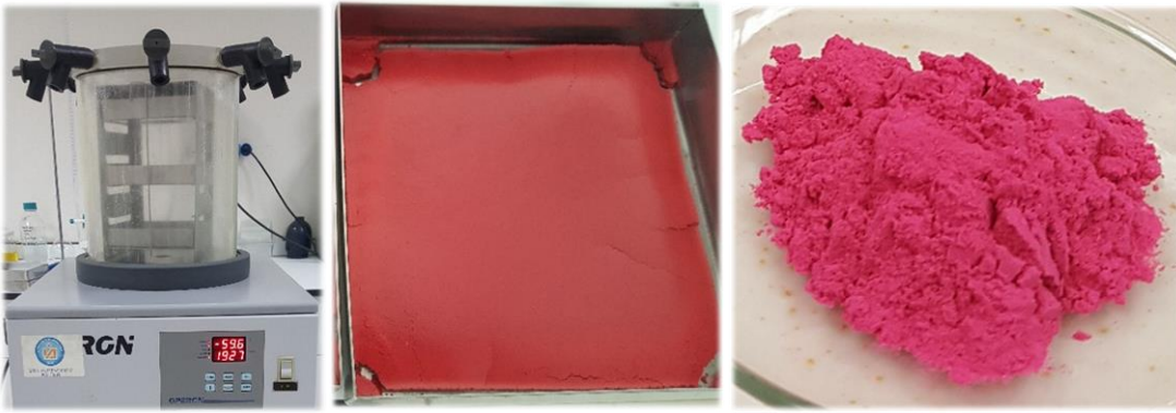
Şekil 3.7. Donuk kurutucu ile toz renklendirici eldesi, (Donuk kurutma (solda), kurumuş ürün (ortada), öğütülerek toz haline getirilmiş son ürün (sağda))
