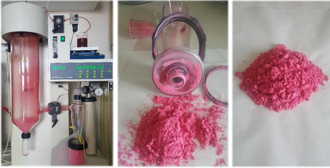
Şekil 3.6. Püskürtmeli kurutucu ile toz renklendirici eldesi, (Püskürterek kurutma (solda), toplama kabından alınan ürün (ortada), son ürün (sağda))
