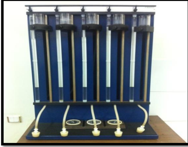
Şekil 3.4. Kalsimetre ve kireç ölçümünden genel bir görünüm
