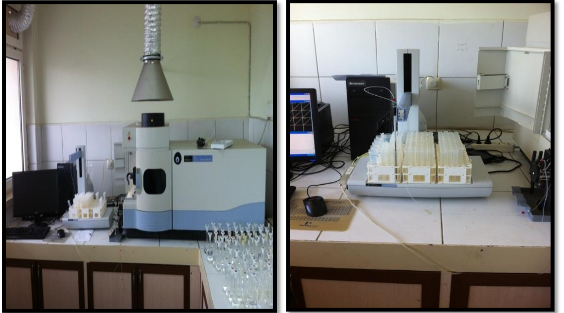
Şekil 3.7. Makro element ve mikro element okumalarının yapıldığı ICP-OES cihazından genel bir görünüm
